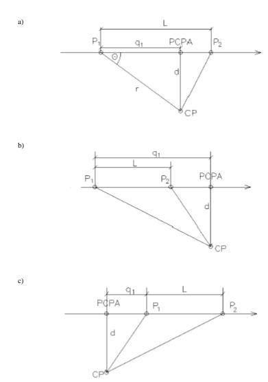
La distanza obliqua d al PCPA definisce i dati da desumere dalle curve rumore-potenza-distanza (NPD) e l'angolo di elevazione. La distanza nel piano orizzontale dal punto di calcolo CP al suolo alla proiezione verticale del PCPA definisce la distanza laterale per il calcolo dell'attenuazione laterale (se del caso).
